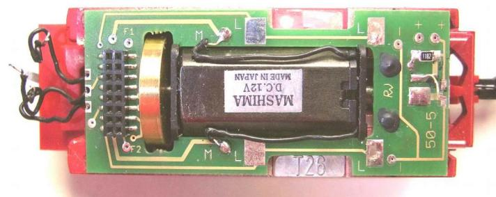
Zwischen Stecker und Buchse entsteht ein kleiner Spalt, auf waagerechten Sitz achten, zwischen Schwungscheibe und Dekoder muss ein kleiner Spalt sein!
