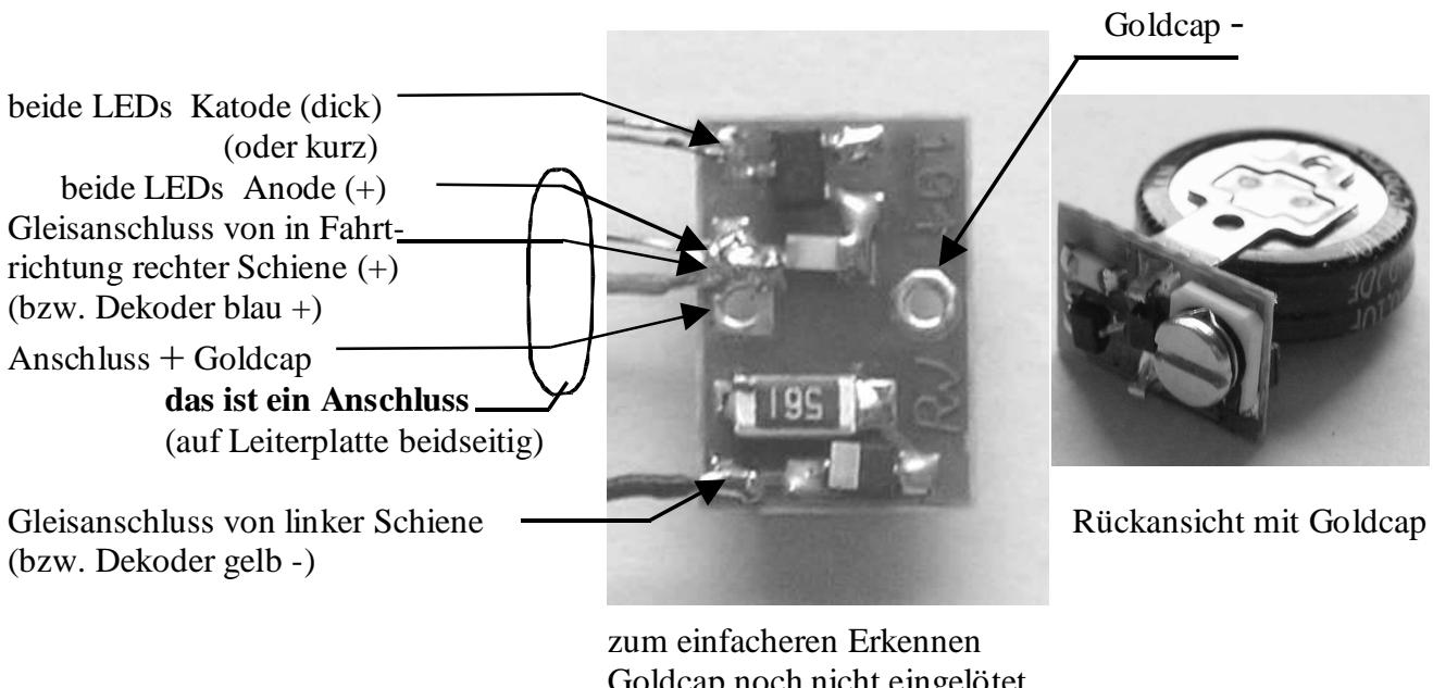
Eine in dem Modell schon vorhandene Diode sollte überbrückt werden. Bei Betrieb mit Wechselspannung leuchten die LEDs fahrtungsrichtungsabhängig.
